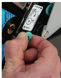
Figure 2-28. Estrazione del Fuso di Alimentazione del Nastro
